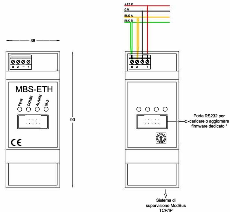
**Attenzione!** Operare sui collegamenti elettrici sempre e solo con modulo disalimentato. Assicurarsi che il voltaggio dell'alimentazione (filo nero "-" e filo rosso "+") sia conforme a quello richiesto dal modulo. I fili giallo e verde devono essere collegati alla comunicazione del sistema REG rispettando il collegamento "entra-esci". Mentre il cavo Ethernet (a cura dell'installatore) deve essere collegato sulla porta Ethernet del modulo.
